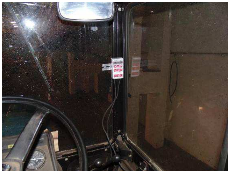
Рисунок 5.26 – Установка пульта управления в кабине трактора
