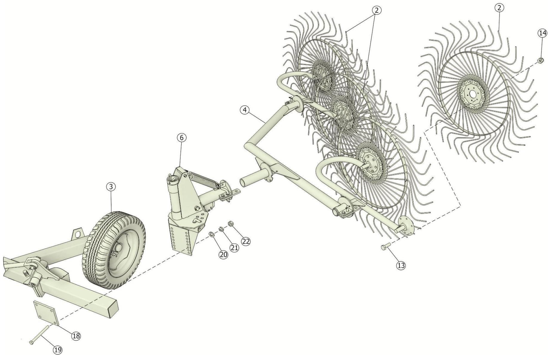
Рисунок 3 – Общий вид ГКП-600 Грабли колесные прицепные ГКП-601.00.000А
