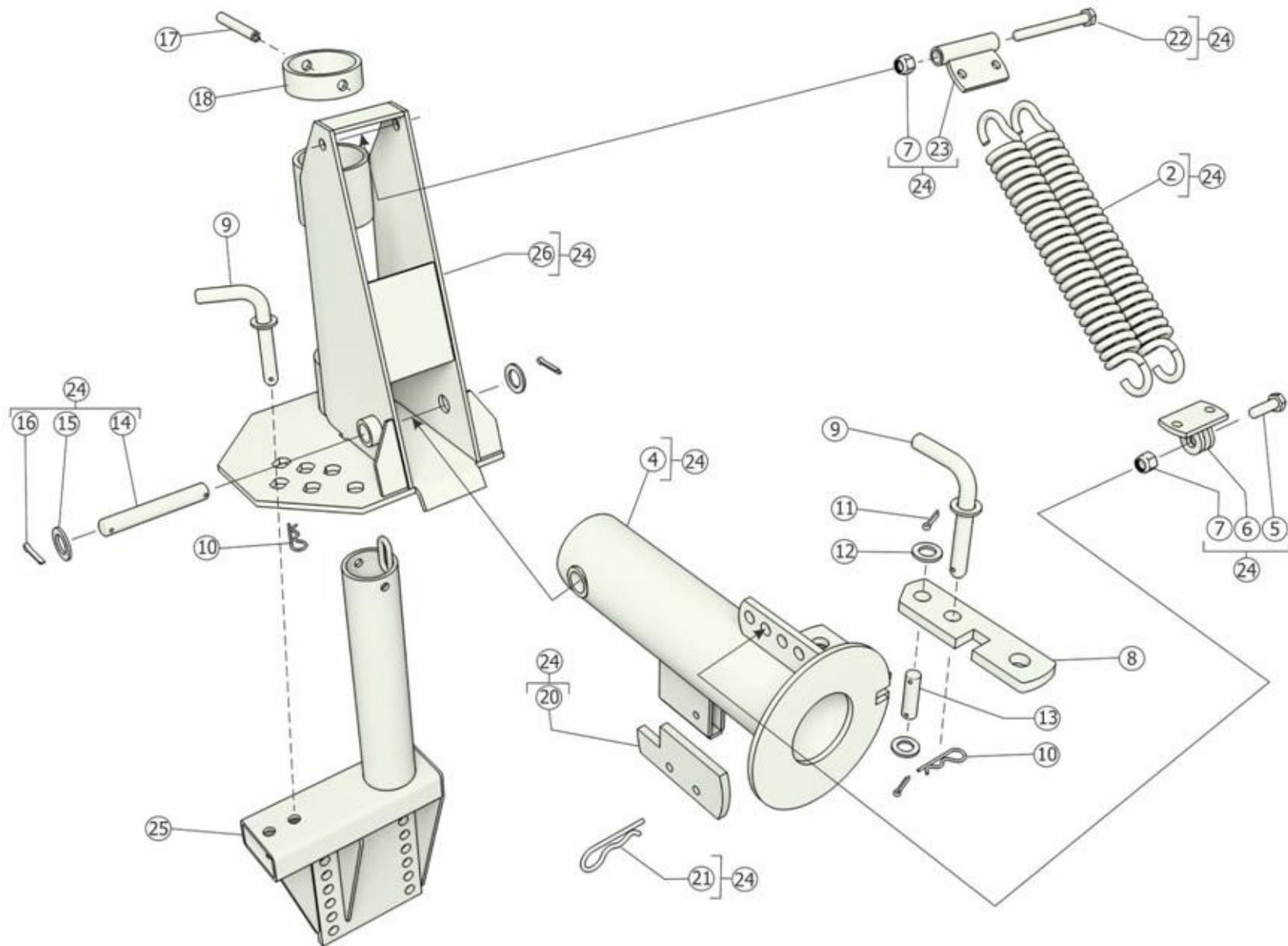
Рисунок 13 - Стойка поворотная ГП-601.03.000-01
