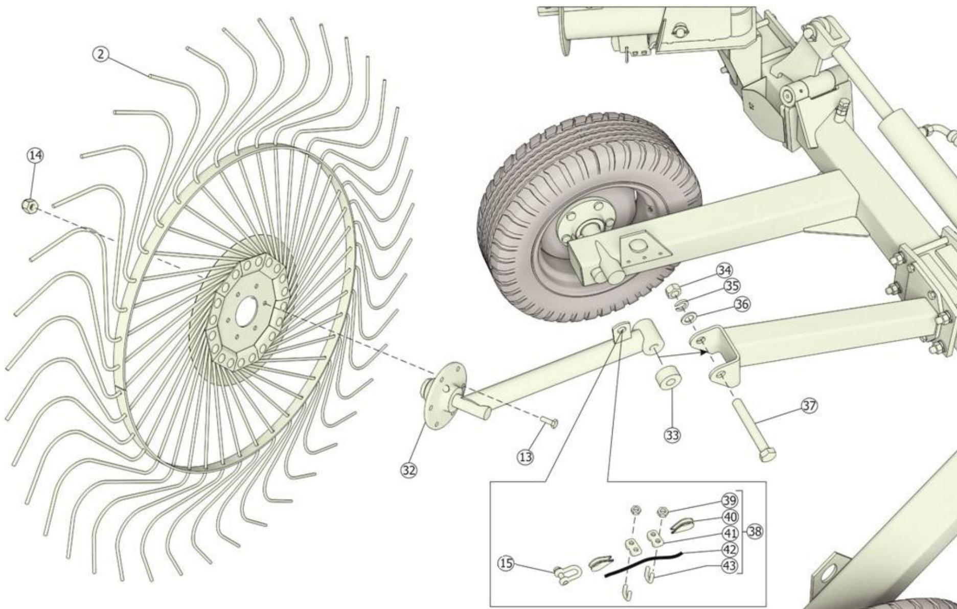
Рисунок 7 – Общий вид ГКП-600-01 Грабли колесные прицепные ГКП-601.00.000А-02
