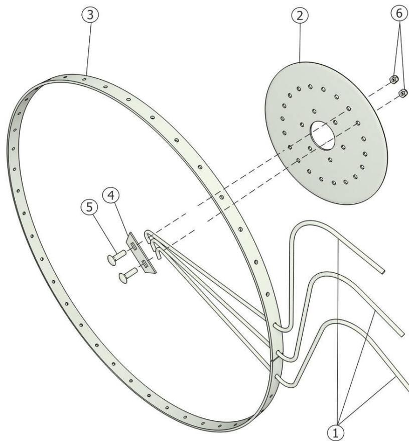
Рисунок 8 - Колесо рабочее ГКП -601.00.050. Колесо рабочее ГКП -601.00.050-01
