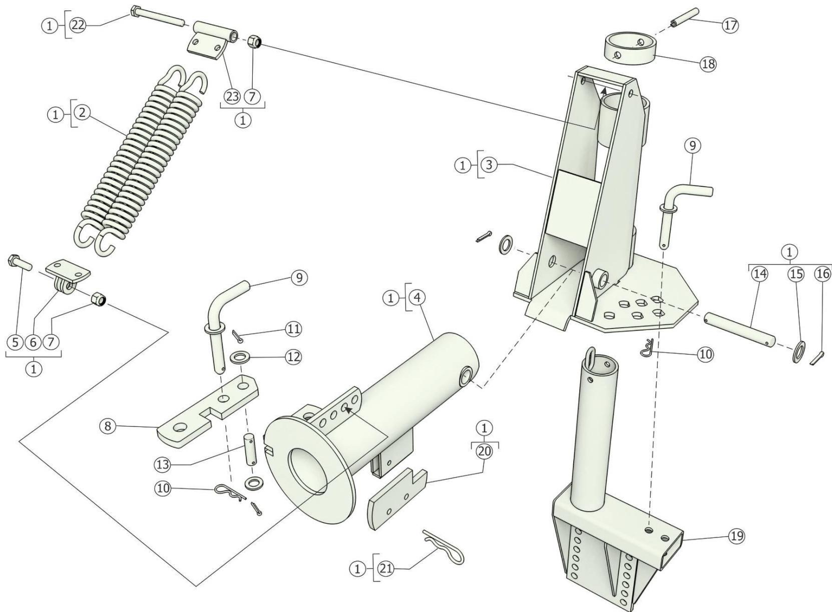
Рисунок 12 - Стойка поворотная ГКП-601.03.000
