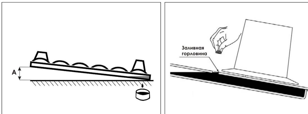
Рисунок 8.2 - Проверка уровня масла в режущем аппарате
