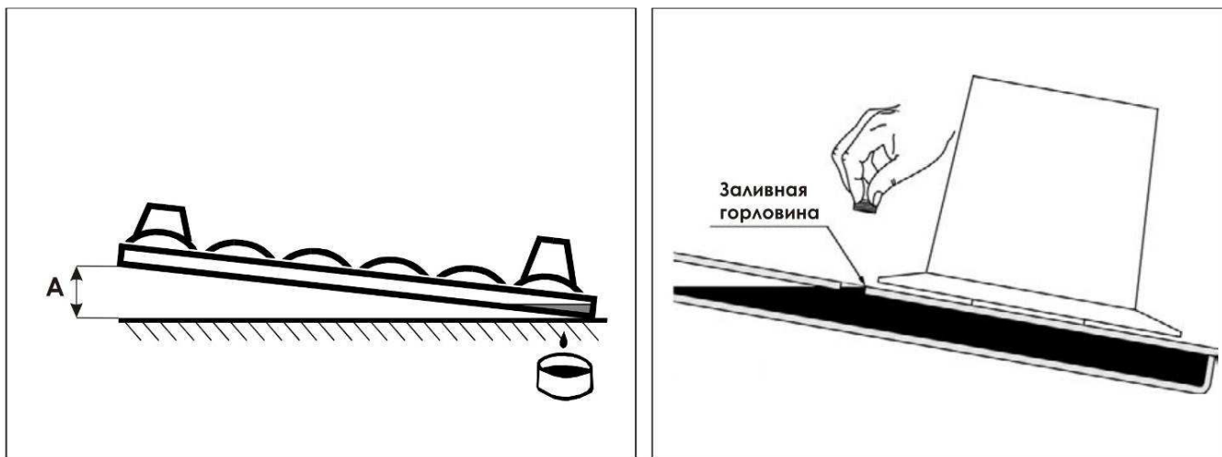
Рисунок 8.3 – Проверка уровня масла в режущем аппарате
