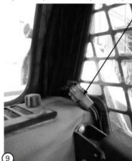
Укладка проводки в кабине
