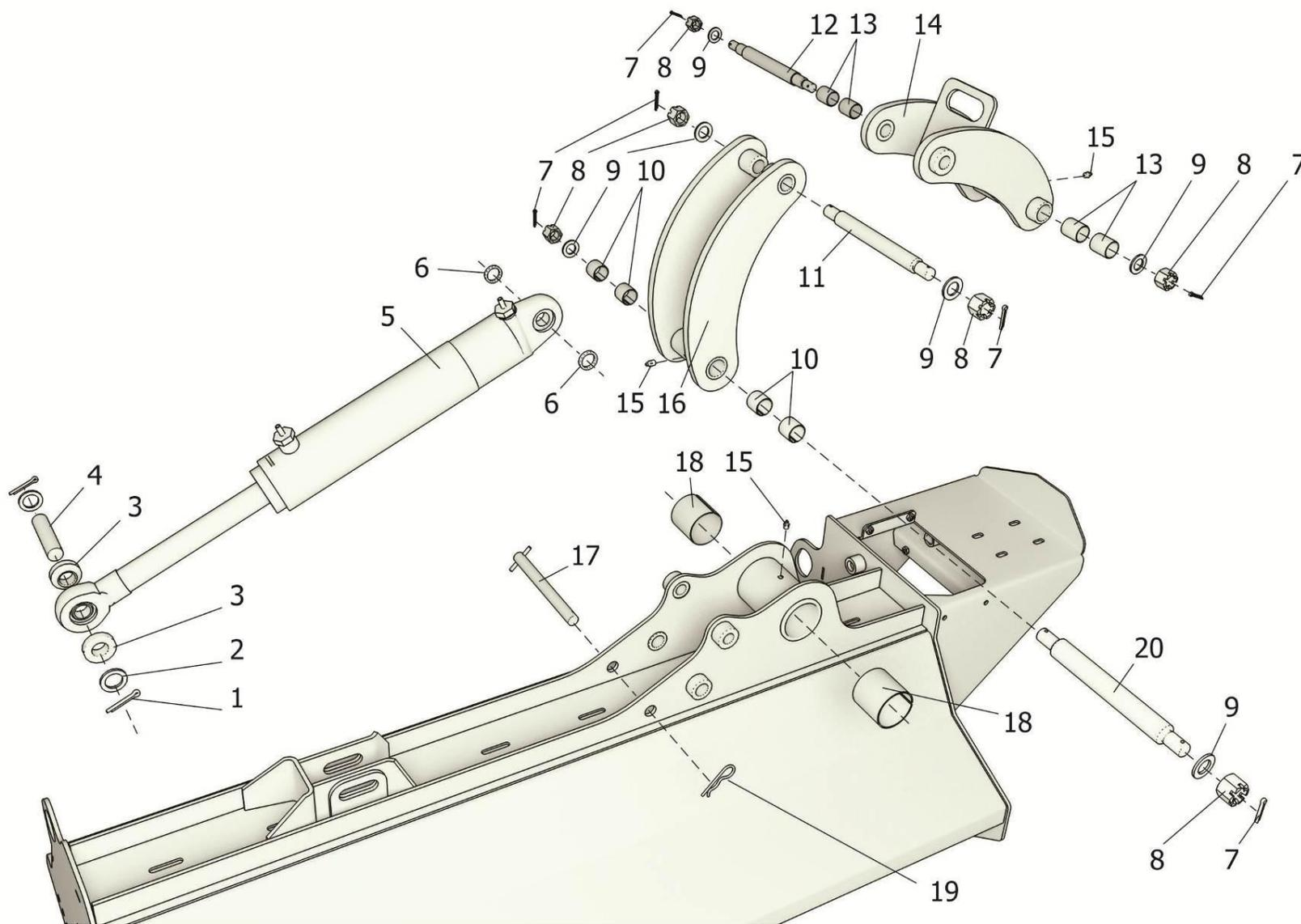
Рисунок 4 - Механизм поворота
