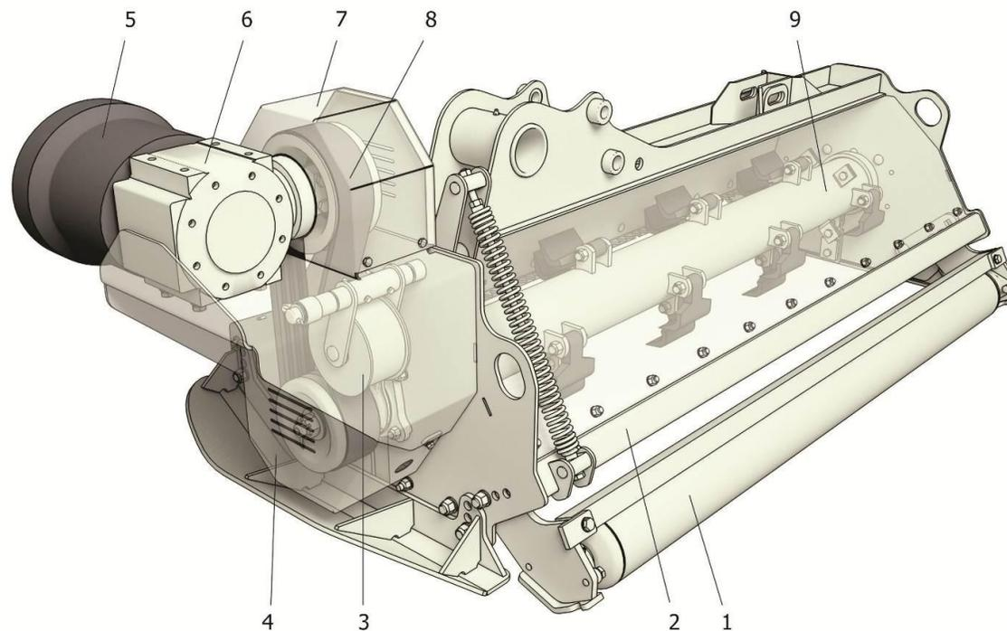
Рисунок 6 - Корпус косилки
