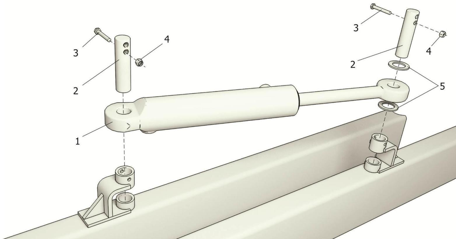
Рисунок 5 - Гидроцилиндр сницы
