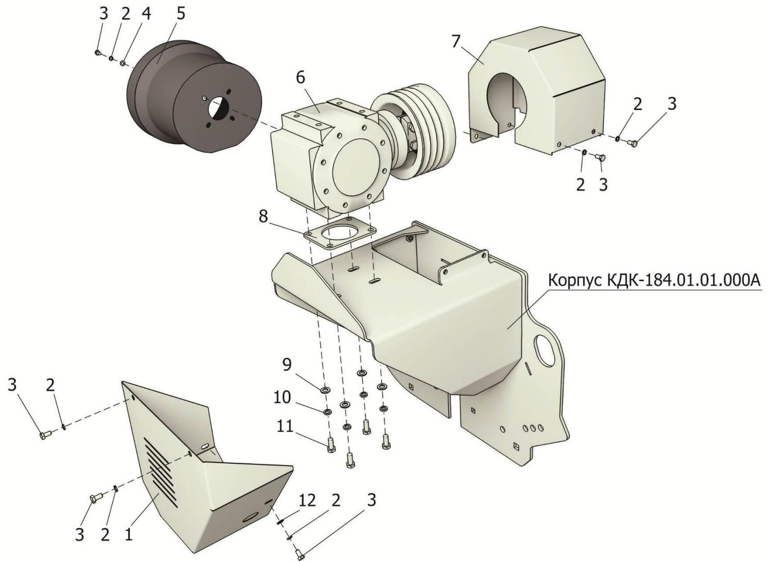
Рисунок 9 - Крепление редуктора и кожухов
