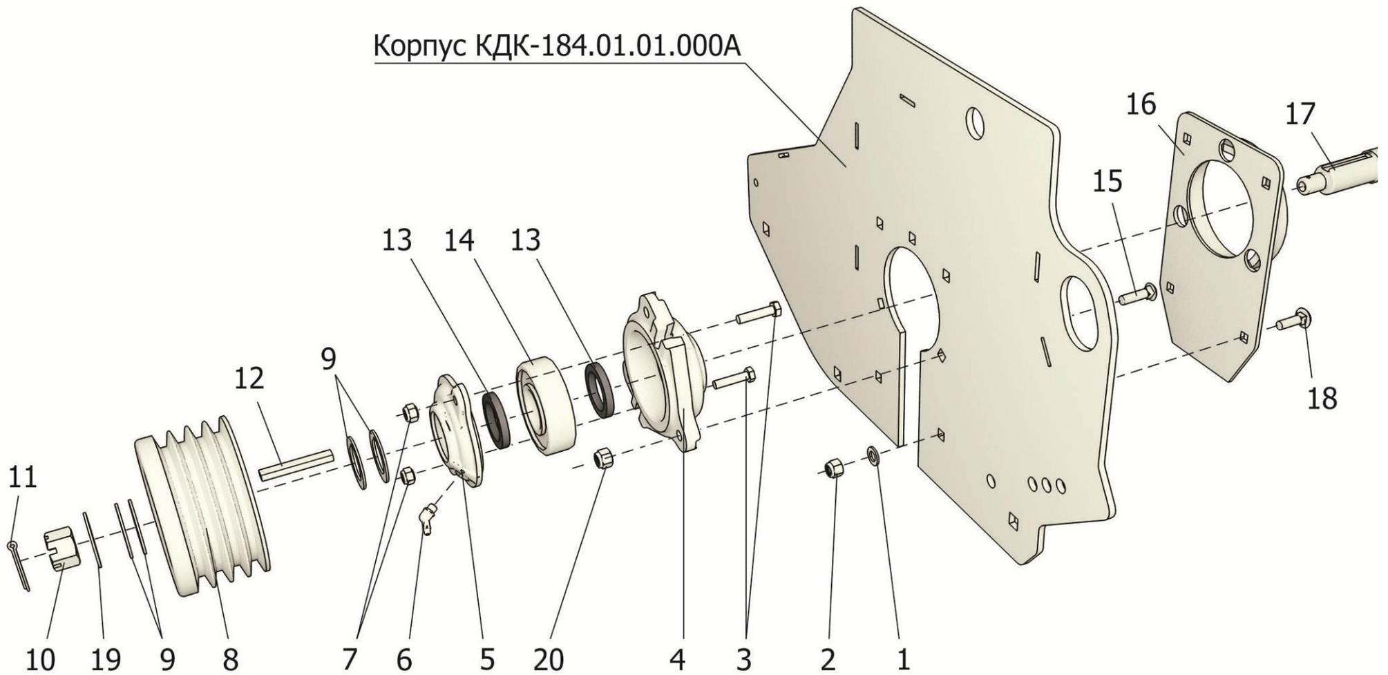
Рисунок 14 - Ротор (левая опора и шкив)
