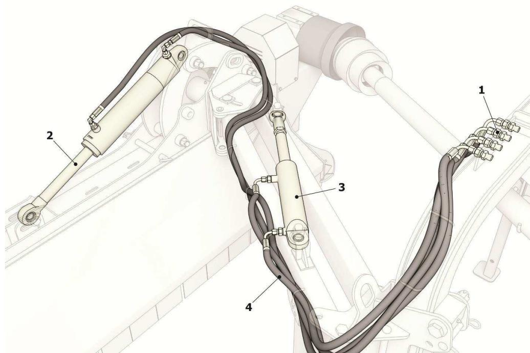
1 – Штуцер; 2 – Гидроцилиндр поворота корпуса в вертикальной плоскости;
