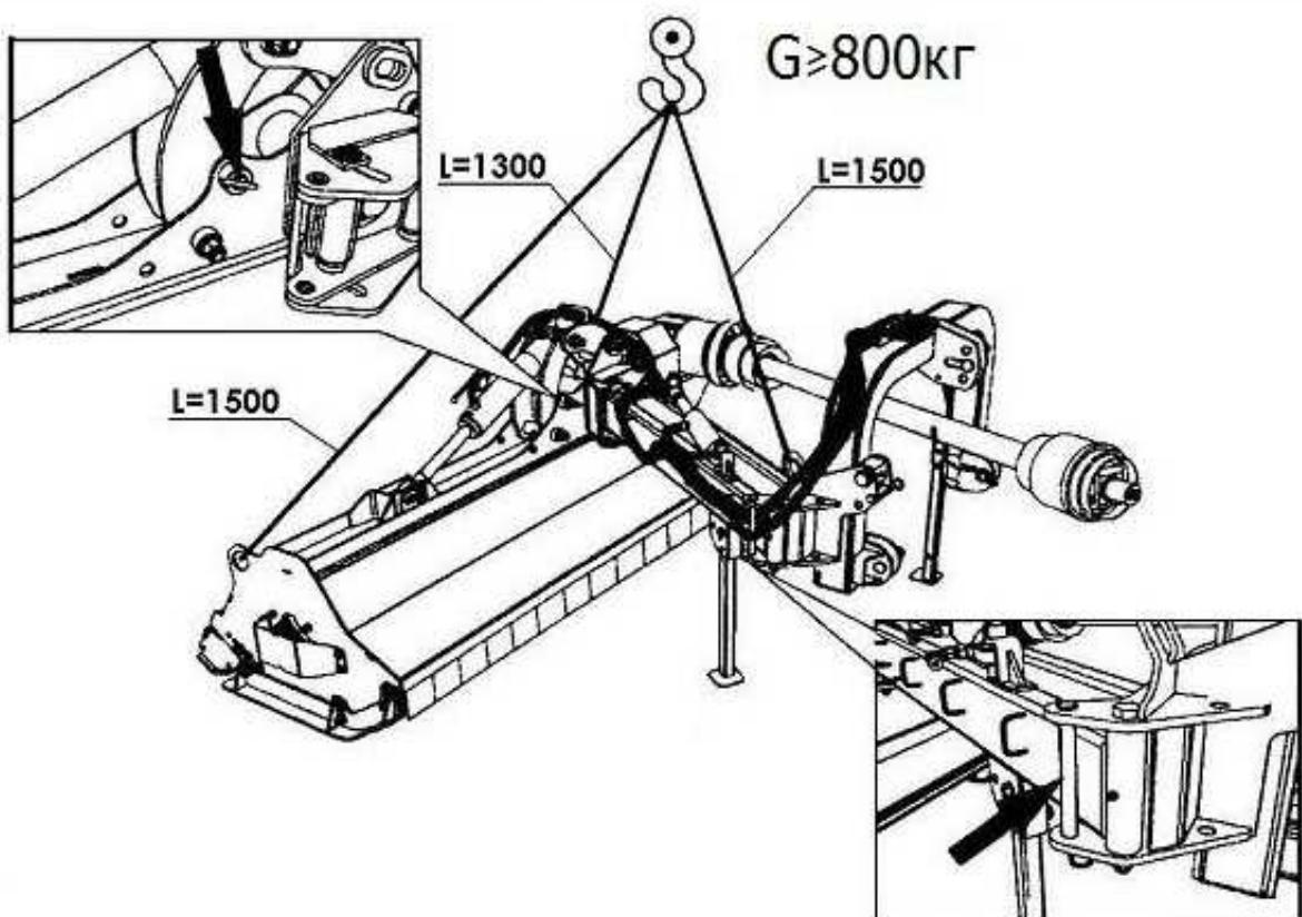
Рисунок 18 – Схема строповки
