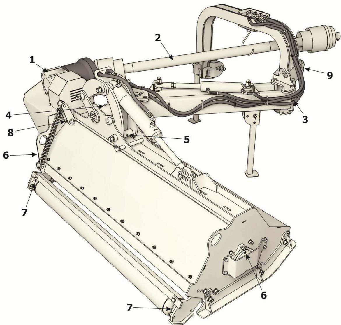
Рисунок 16 – Объекты смазки косилки
