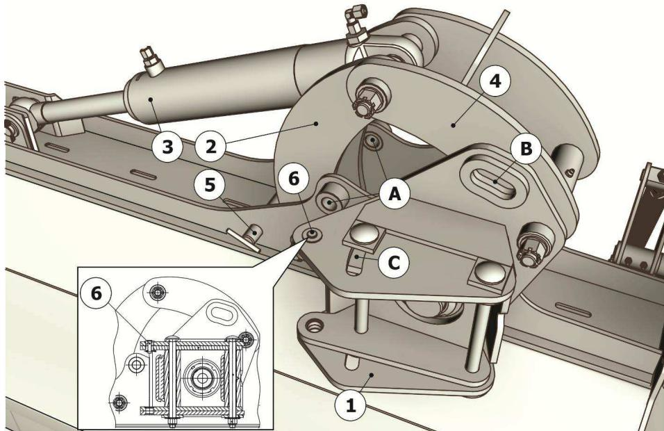
1 – Поворотная голова; 2 – Дуга; 3 – Гидроцилиндр; 4 – Дуга; 5 – Фиксатор;
