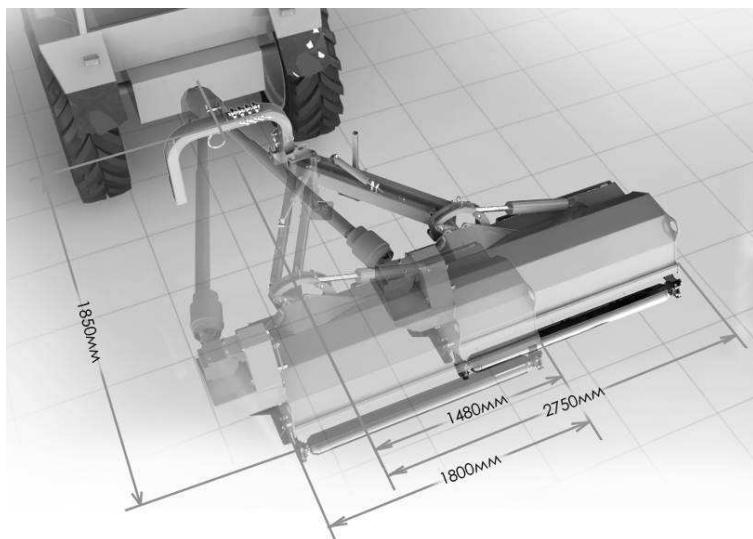
Рисунок 4 – Рабочие положения косилки в горизонтальной плоскости
