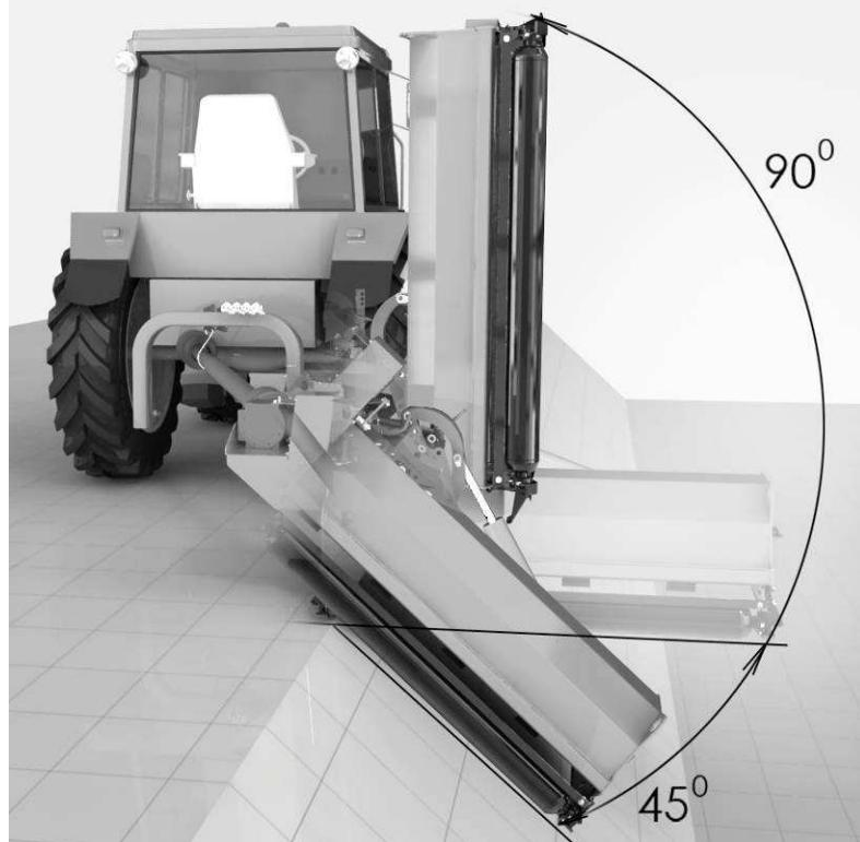
Рисунок 3 – Рабочие положения косилки в вертикальной плоскости
