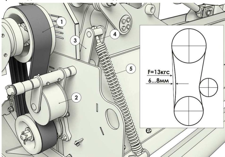
1 – Ремень поликлиновой; 2 – Ролик натяжной; 3 – Натяжник; 4 – Болт натяжения; 5 – Пружина
