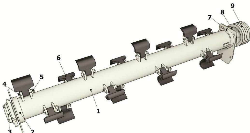
1 – Вал ротора; 2 – Кожух; 3 – Подшипниковая опора; 4 – Болт; 5 – Гайка; 6 – Нож молотковый;
