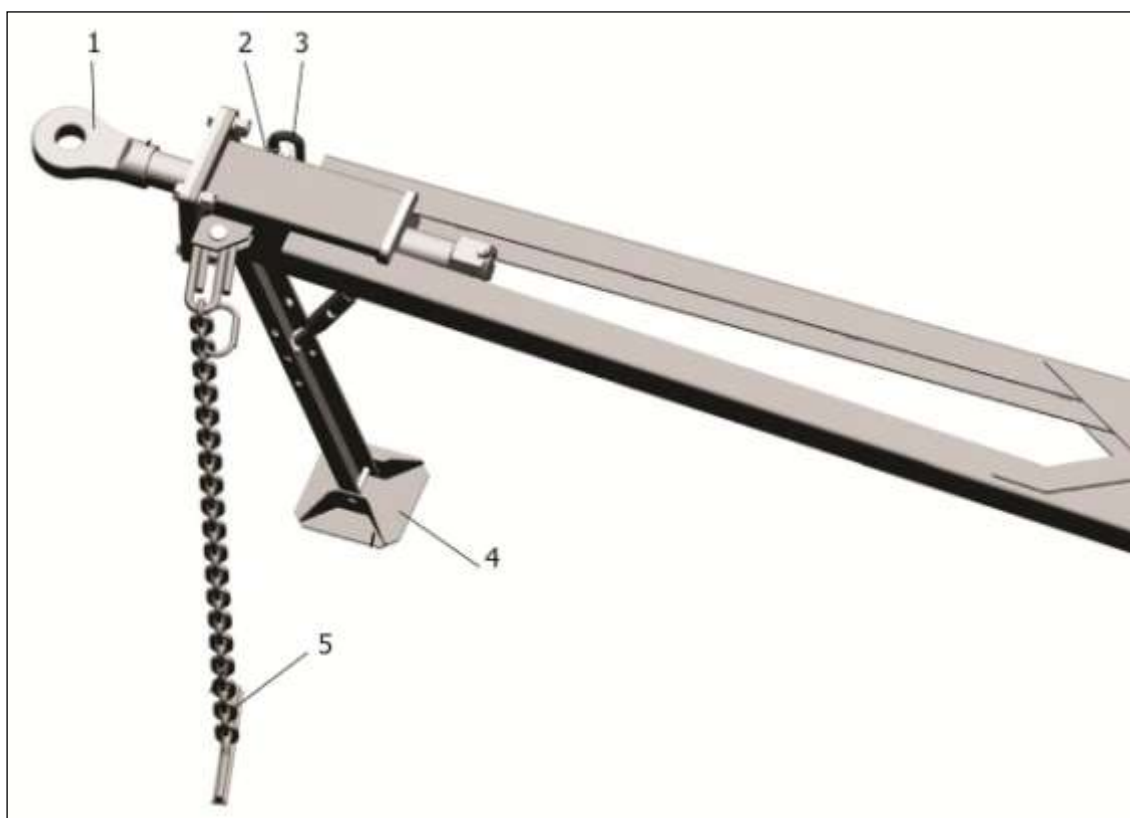
1 - серьга; 2 - вилка; 3 - жгут приспособления; 4 - стойка; 5 - цепь Рисунок 2.2 - Передняя часть приспособления
