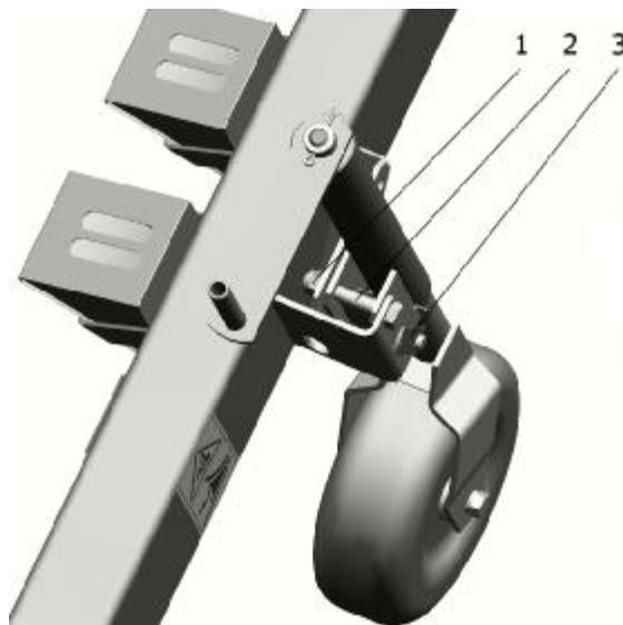
1 – самоконтрящаяся гайка; 2 – болт М16х95; 3 – фиксатор
