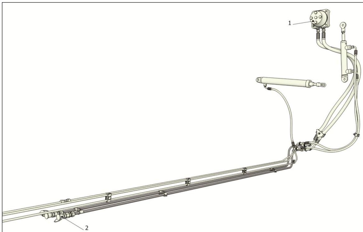
1-гидромотор привода мотовила; 2-места присоединения к гидросистеме комбайна
