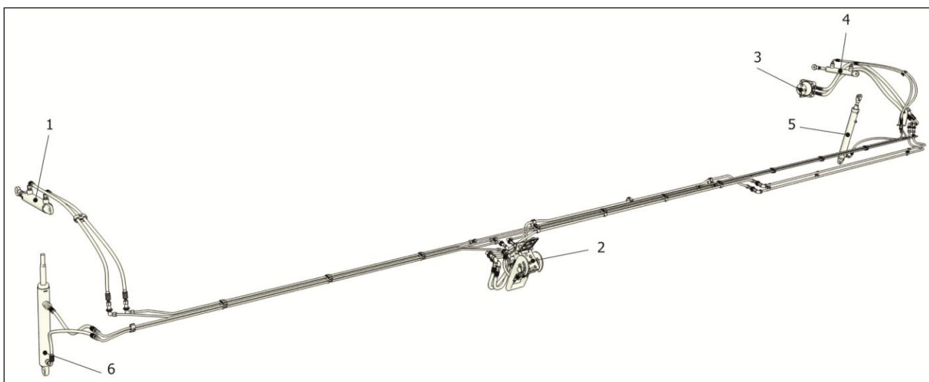
1, 4 - гидроцилиндры горизонтального выноса мотовила; 2 - единый гидроразъем; 3 - гидромотор; 5, 6 - гидроцилиндры подъема/опускания мотовила
