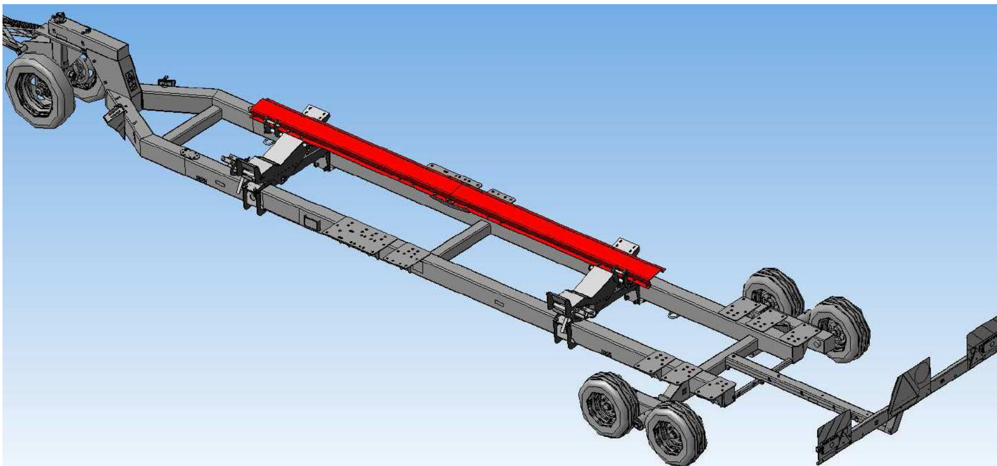
Рисунок Д.2 – Приспособление для перемещения адаптеров ППА-4000 "Uni Cart 4000" для RSM SS-490 (с комплектом для транспортировки SS-490.13.00.000A)
