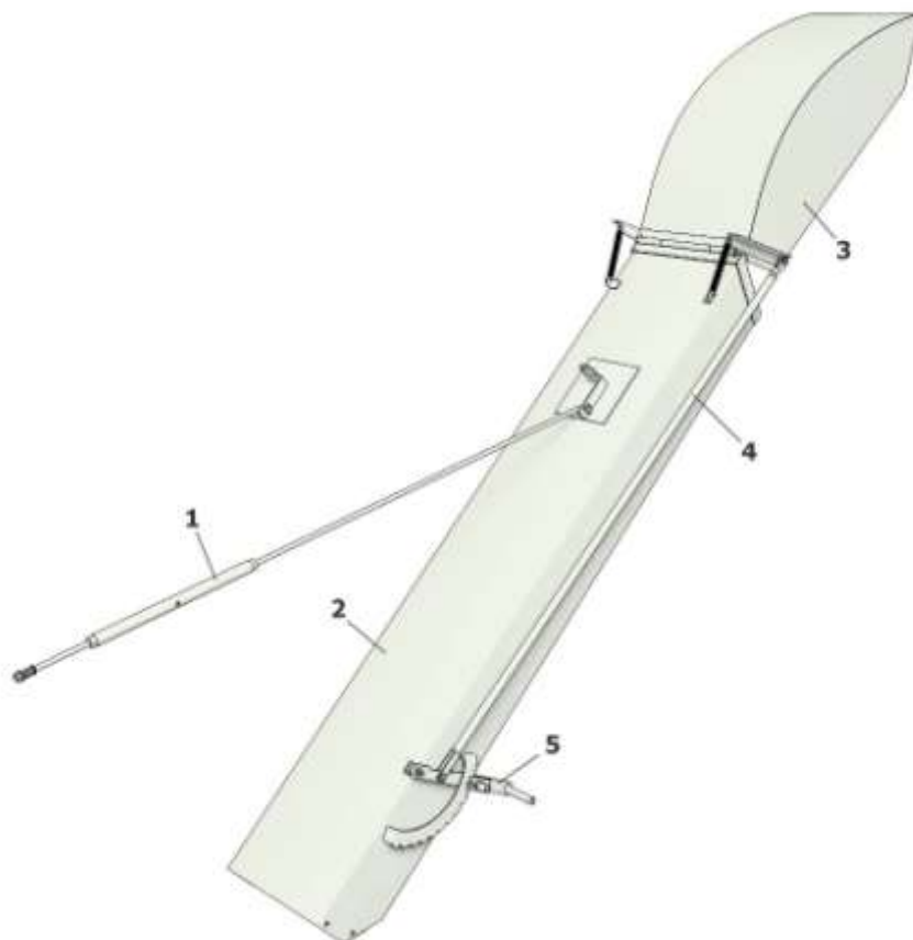
1-Тяга натяжная; 2-Короб; 3-Носок откидной; 4-Тяга; 5-Рычаг Рисунок 2.10 – Желоб
