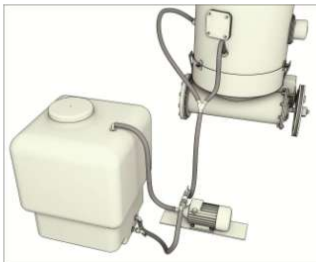
Рисунок - 5.1 Схема подключения трубопроводов приставки
