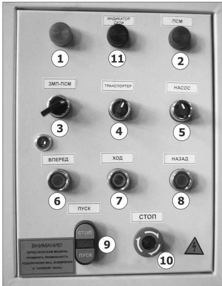
1-Индикатор режима метания (ЗМП); 2-Индикатор режима протравливания (ПСМ); 3-Переключатель режимов ЗМП-ПСМ-01; 4-Управление загрузочным транспортером; 5-Управление протравливающей приставкой; 6-Движение вперед; 7-Отключение хода; 8-Движение назад; 9- ПУСК-СТОП; 10-Аварийный СТОП; 11-Индикатор сети
