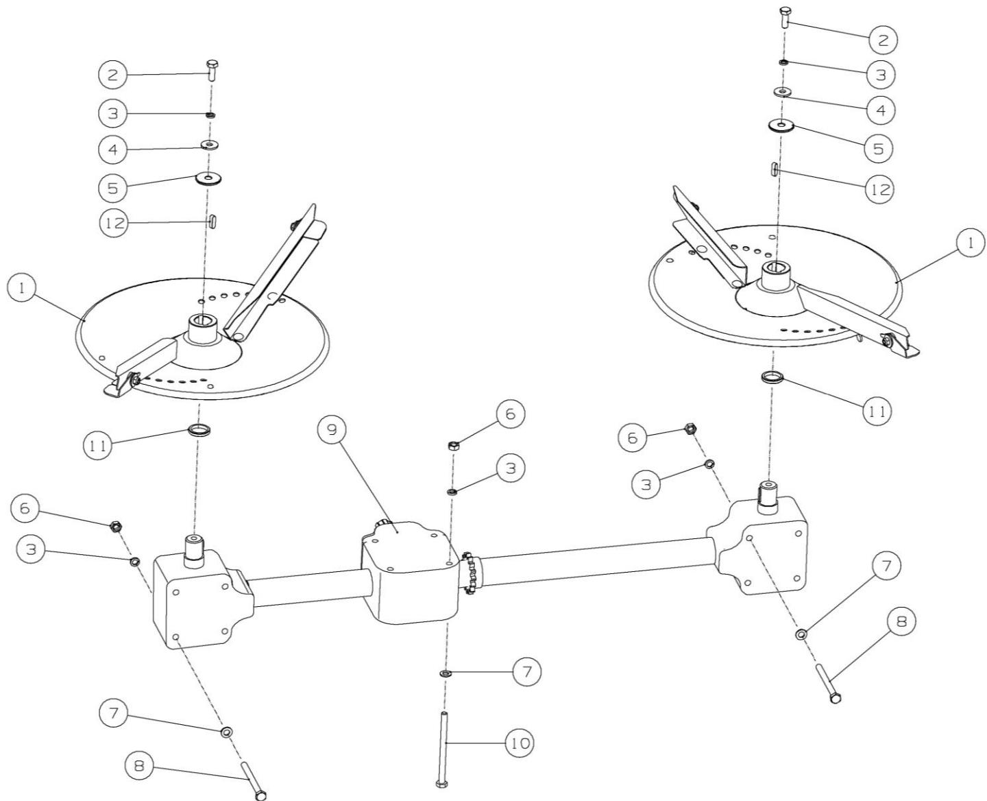
Рисунок 4 – Установка редуктора РА-900.70.000Б
