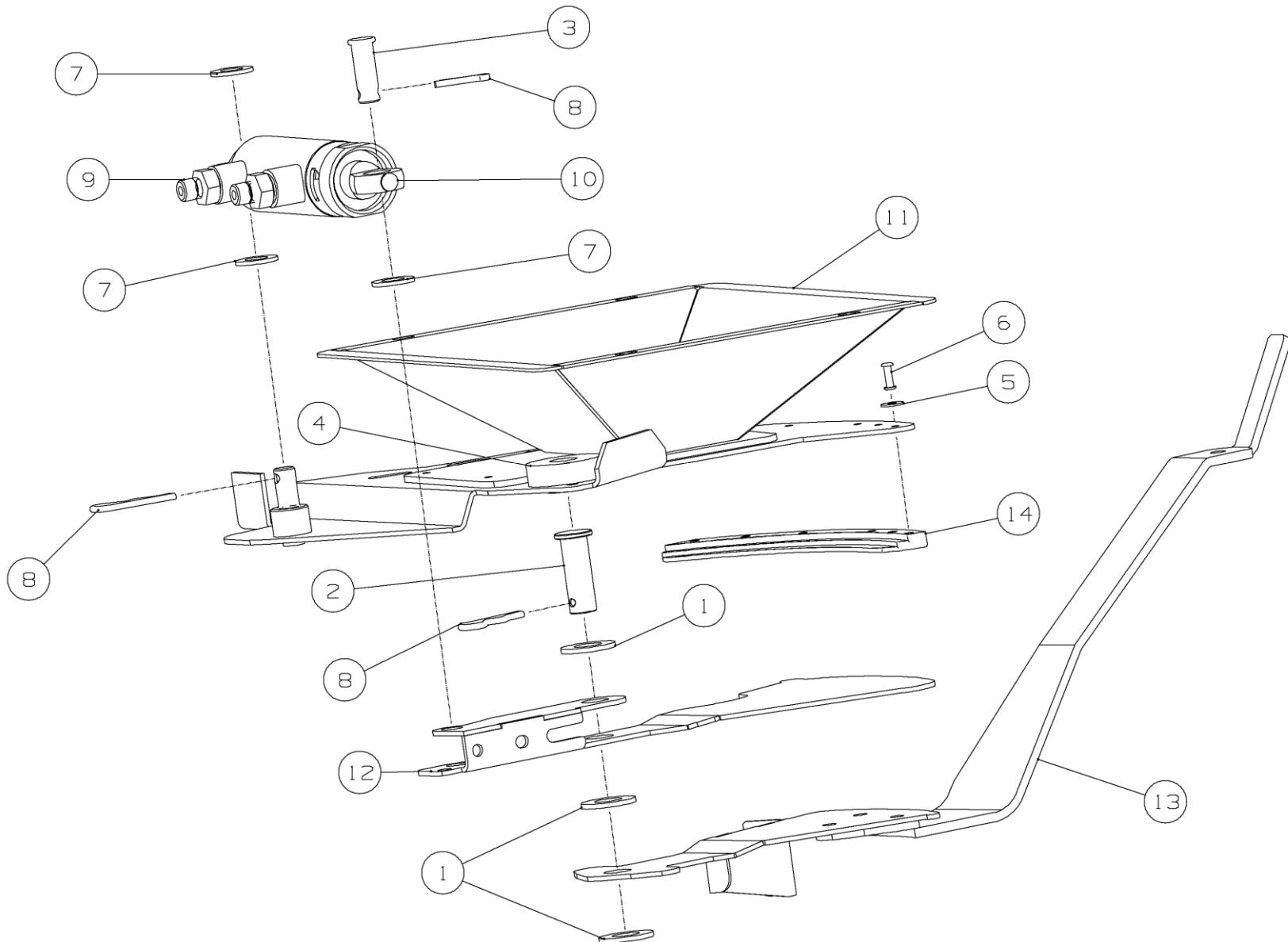
Рисунок 8 Механизм регулировки высева - РА-900.60.00.000 и РА-900.60.00.000-01
