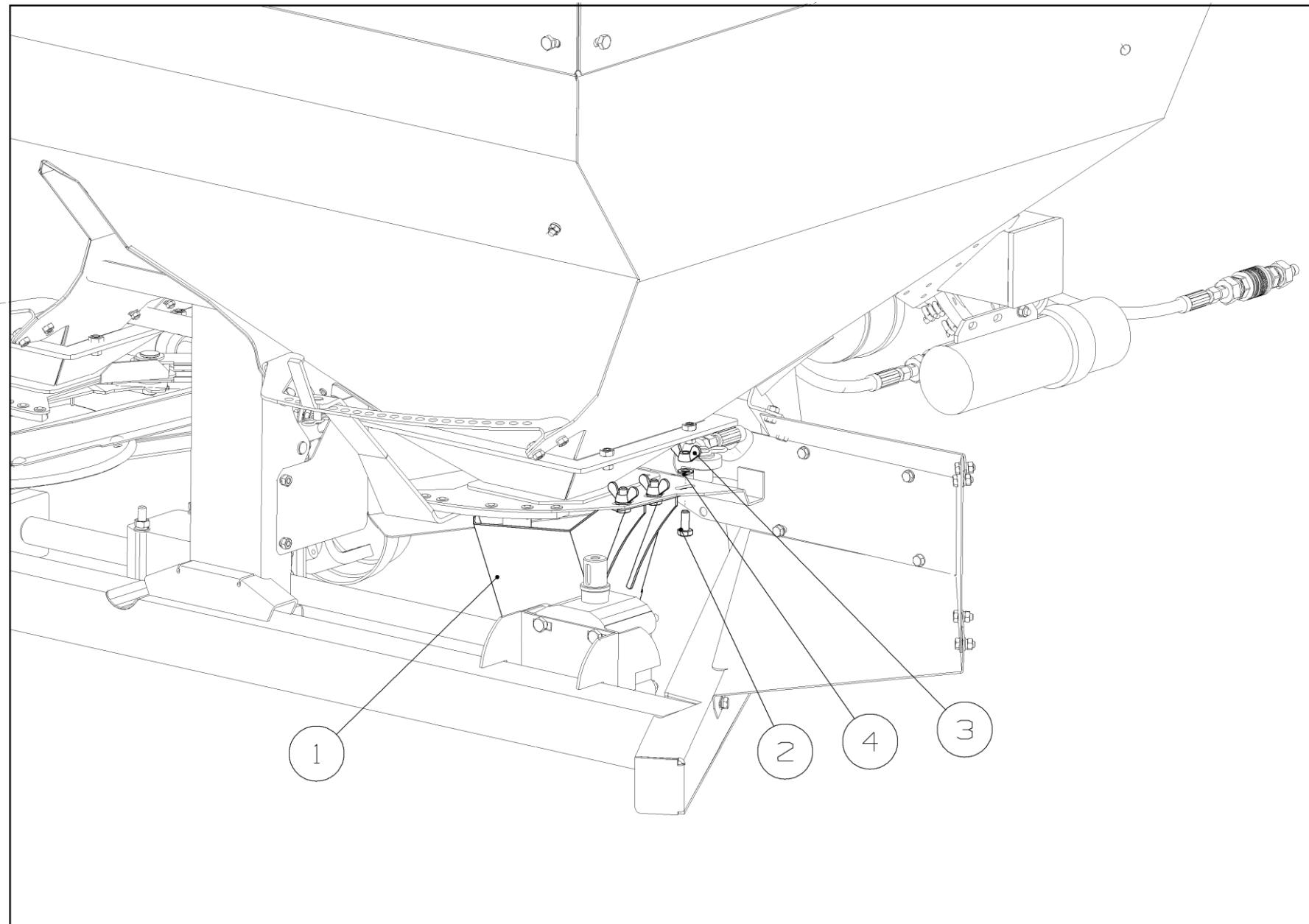
Рисунок 7 - Установка лотка РА-1000.00.01.000
