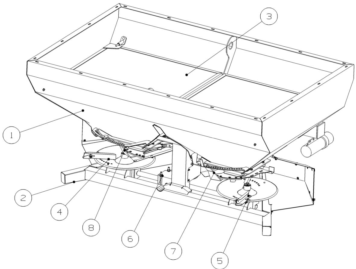
1-Бункер; 2-Рама; 3-Решетка; 4, 5-Диск; 6-Редуктор; 7, 8-Механизм регулировки высева
