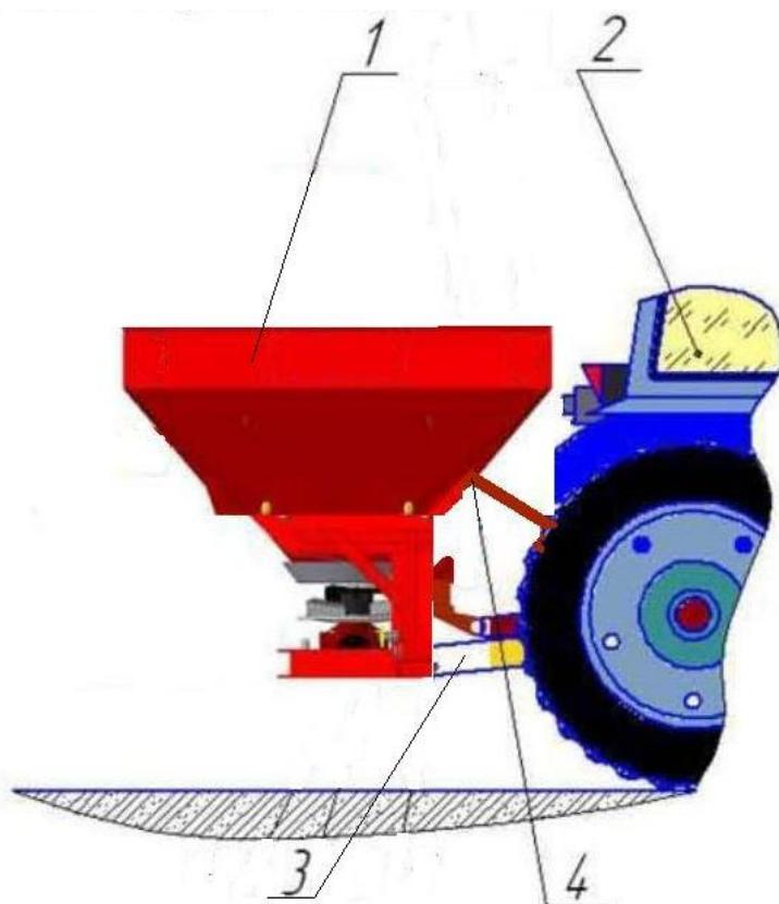
1- Разбрасыватель; 2-Трактор; 3-Карданный вал; 4-Палец
