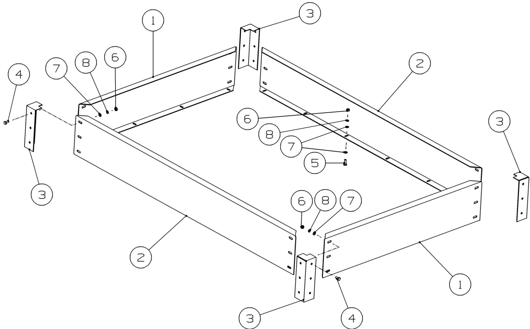
Рисунок 9 - Установка надставки - РА-1000.11.00.000
