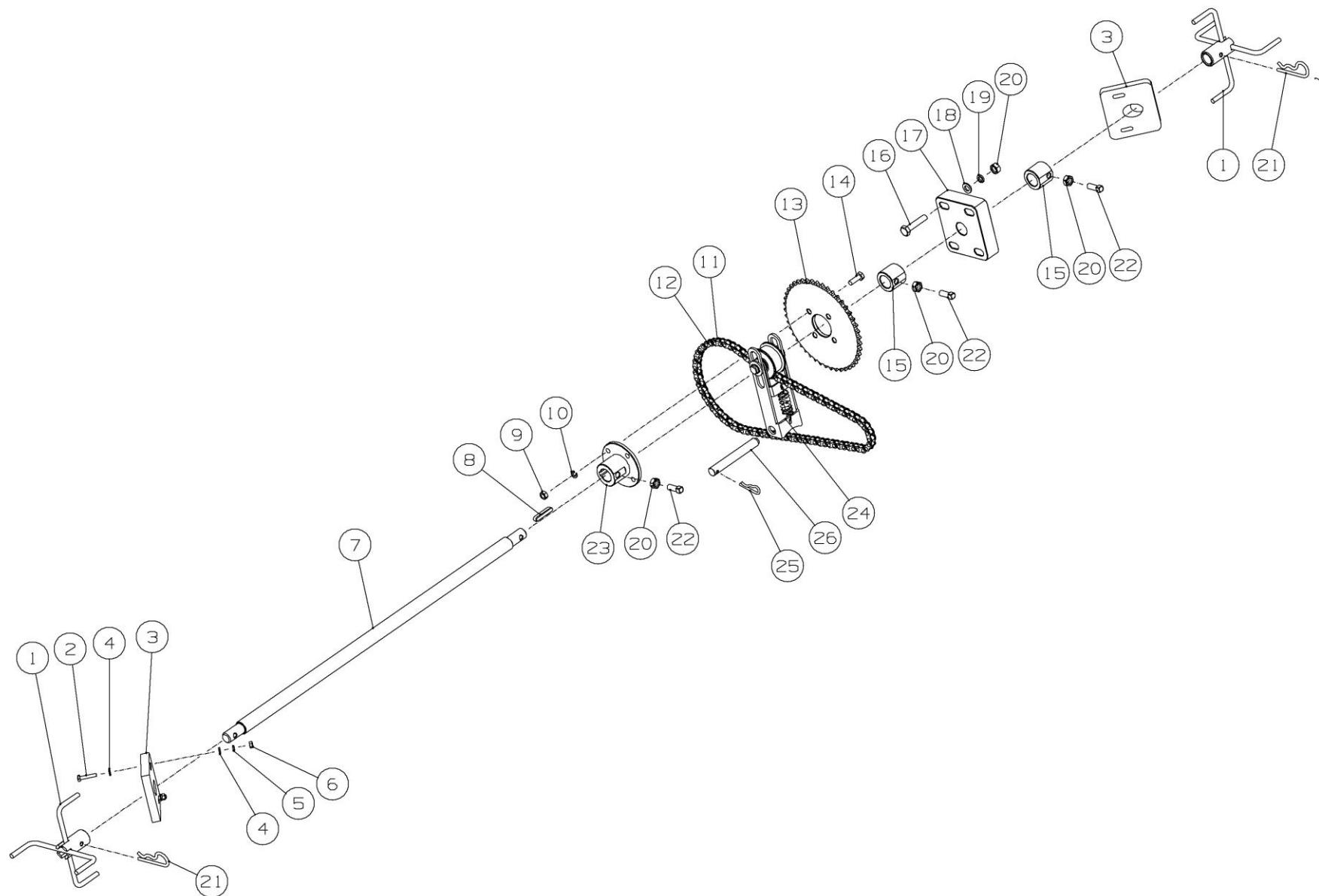
Рисунок 5 – Установка ворошилки РА-900.90.00.000Б
