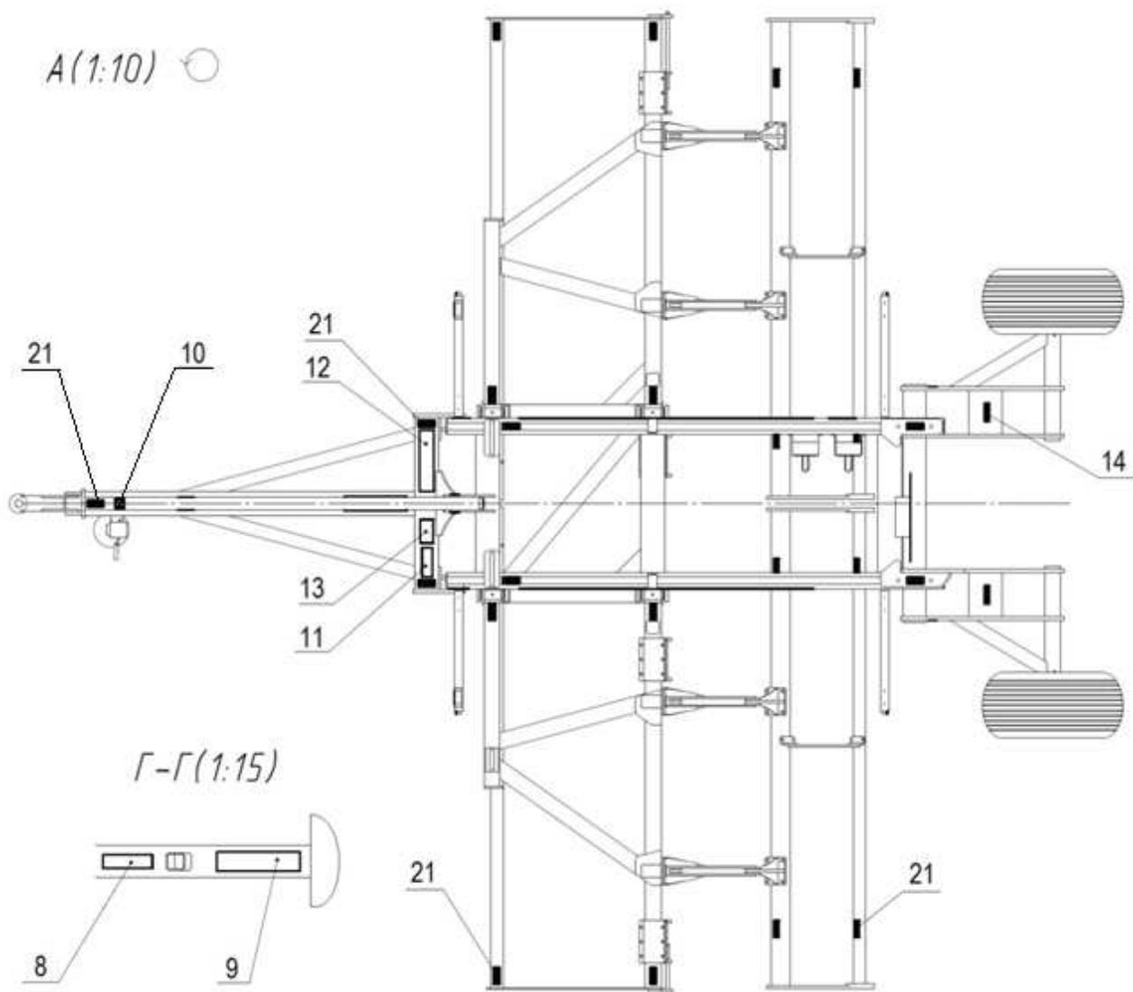
Рисунок 10.1 – Места расположения табличек, аппликаций на мульчировщике
