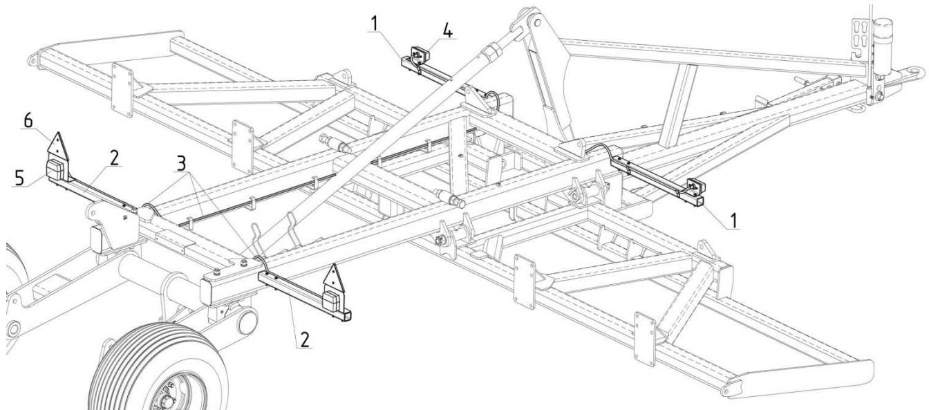
1,2 – кронштейн для фонарей; 3 – жгут электропроводки; 4 – фонарь передний; 5 – фонарь задний;
