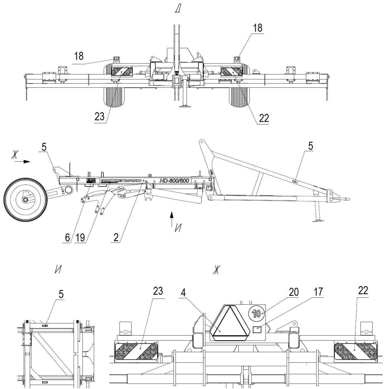
Рисунок 10.2 – Места расположения табличек, аппликаций на мульчировщике
