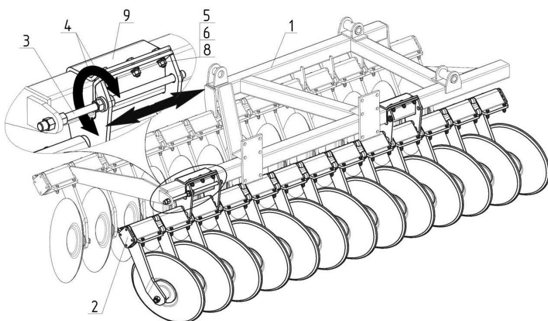
1 – крыло; 2 – брус рабочих органов; 3 – винт регулировочный; 4 - гайка;
