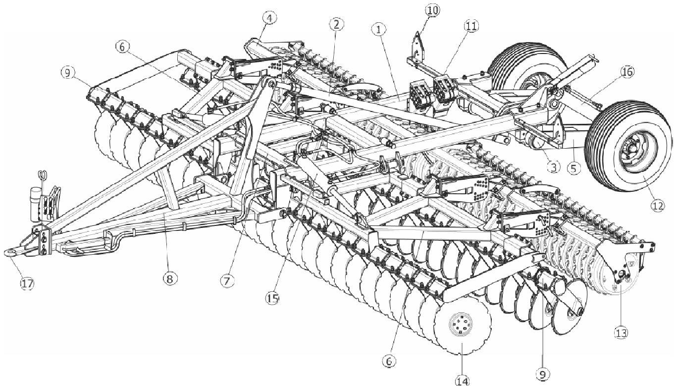
1 – рама; 2 – тяга; 3 – подшипниковая опора; 4 – установка катков; 5 – шасси; 6 – установка крыльев;
