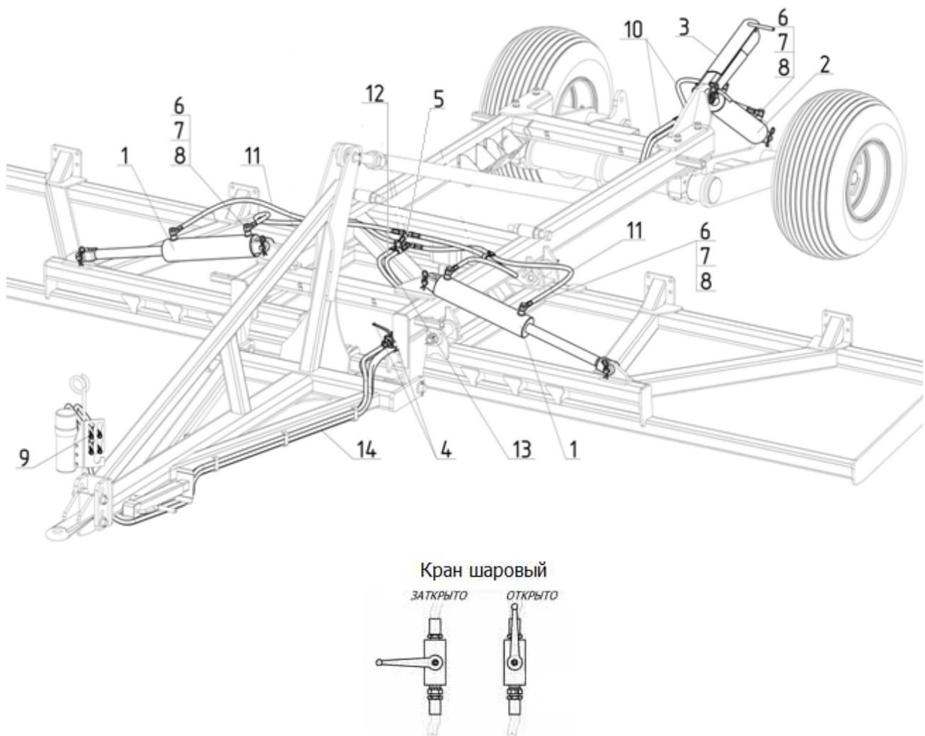
1 – гидроцилиндр для подъема рамной конструкции; 2 – гидроцилиндр для подъема рамы шасси; 3 – упор в сборе; 4 – кран шаровый; 5 – тройник для труб одного диаметра; 6 – болт специальный; 7 – штуцер накидной; 8 – шайба; 9 – муфта разрывная; 10 – рукав высокого давления L=9500 мм; 11 – рукав высокого давления L=1500 мм; 12 – рукав высокого давления L=7000 мм; 13 – рукав высокого давления L=850 мм; 14 – рукав высокого давления L=6000 мм
