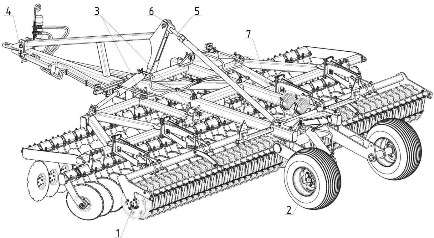
Рисунок 15 – Схема смазки мульчировщика HD-800/600
