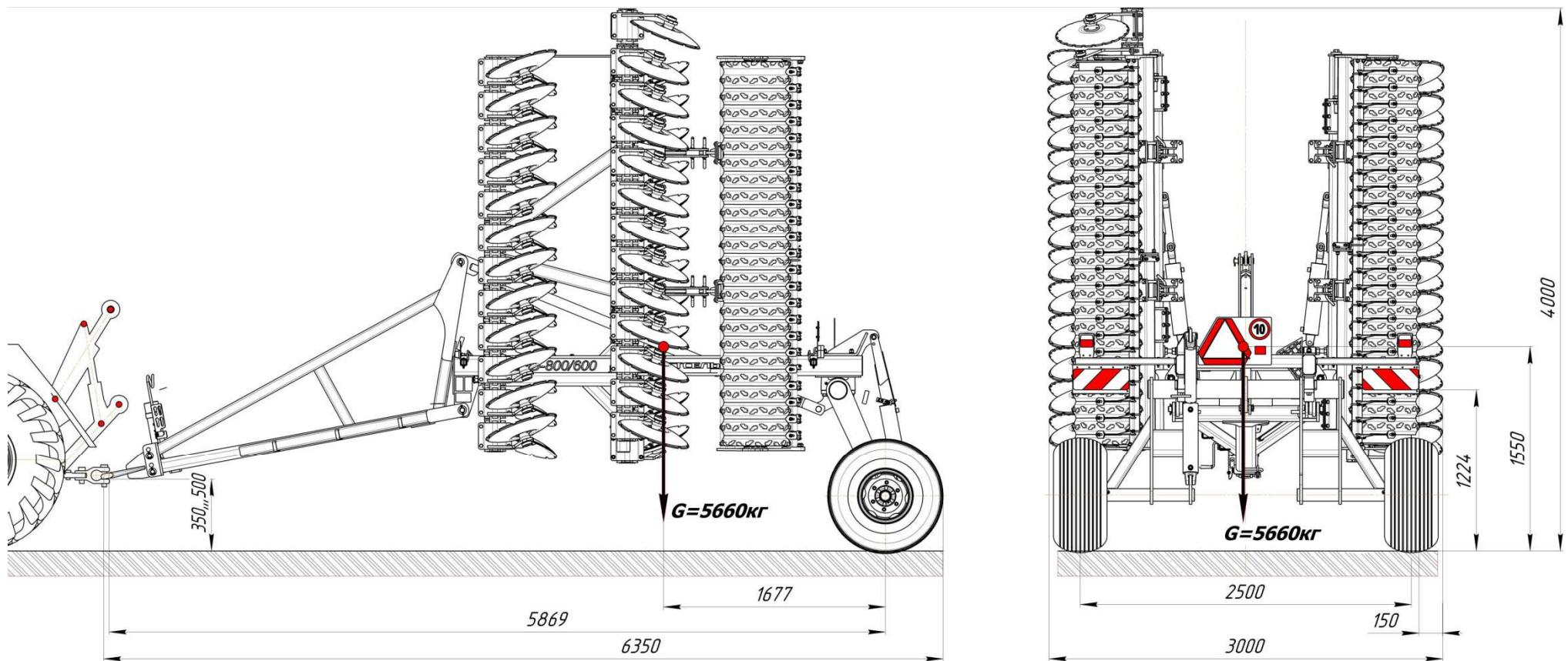
Рисунок В.1 – Схема расположения центра масс в транспортном положении
