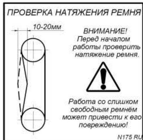
**Рис. 27.** Контроль и натяжение зубчатого ремня
